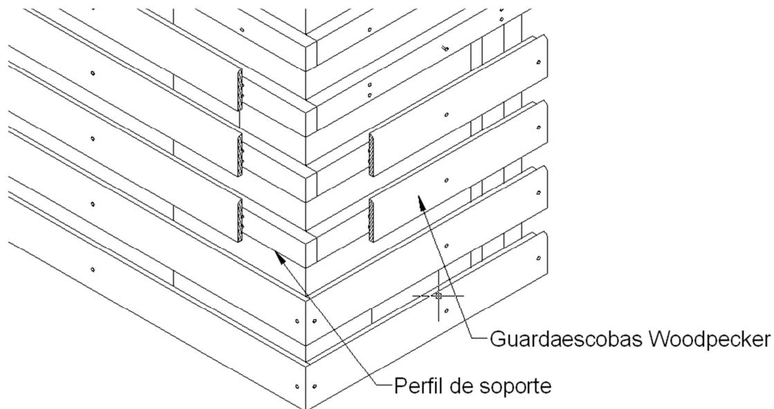
El perfil Woodpecker® también puede utilizarse para cerramientos trenzados como el que se muestra a continuación. En este caso la distancia entre los elementos de apoyo puede ser de 60 cm ya que no es requerida la rectitud del perfil.
